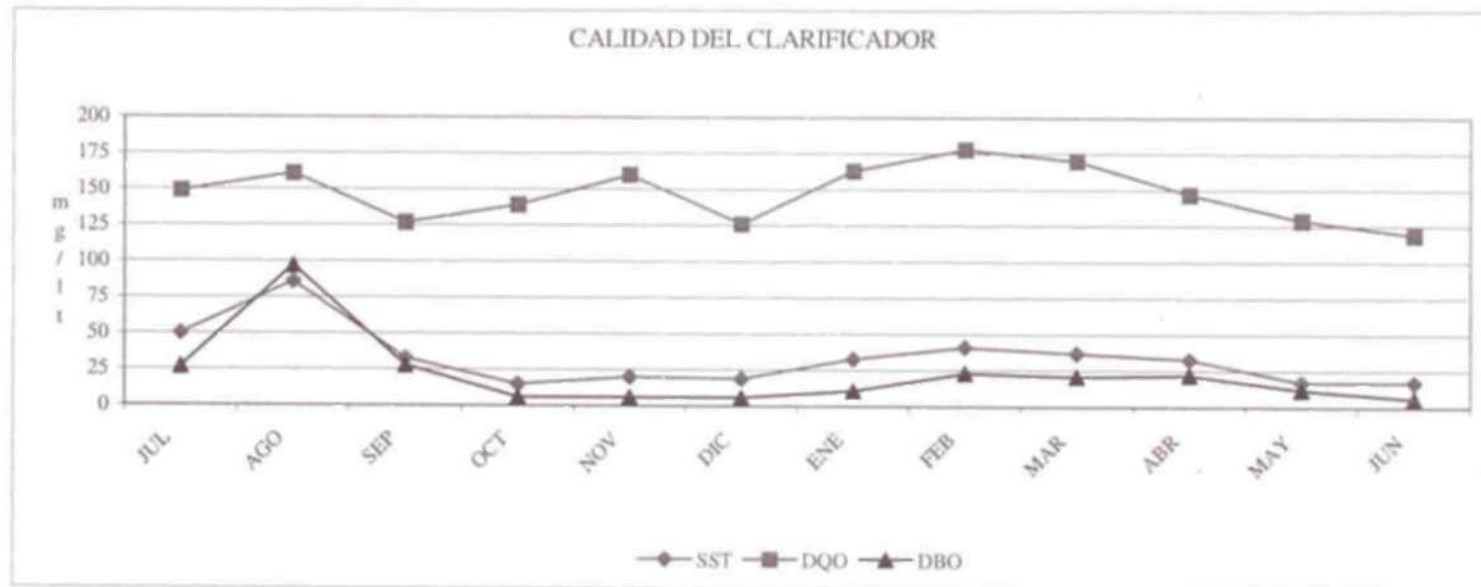
Figura 5.7. Parámetros de calidad del agua al salir del clarificador.
