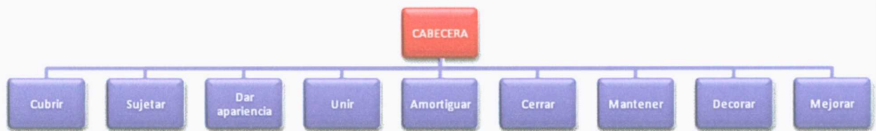
Figura 5.15 Funciones de las partes de la cabecera nivel 2 de la descomposición funcional
