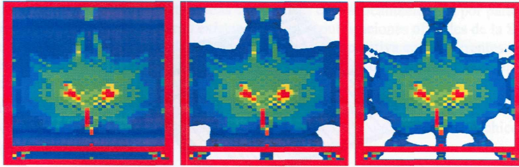
Fig. 8.5 Optimización en Optistruct del piso.
