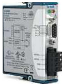
Figura 3.5: La tarjeta tiene leds que indican si ha ocurrido una falla por sobrevoltaje, bajo voltaje, alta temperatura o corto circuito.
