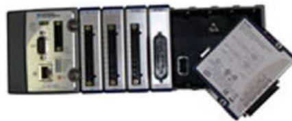
Figura 3.4: El chasis cRio soporta hasta 8 tarjetas de entrada y salida.
