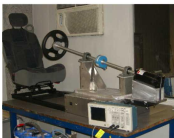
Figura 3.1: Sistema diseñado para el sistema steer by wire ubicado en el laboratorio de autotrónica.
