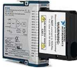
Figura 3.8: La tarjeta tiene 32 terminales para una configuración de 16 canales diferenciales.
