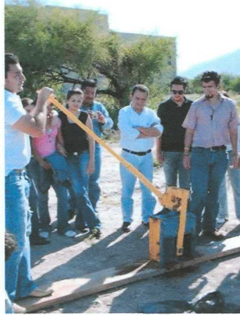
Figura 8. Proceso de compactación, práctica en la ULSA, Cd. Victoria, Tamaulipas. Fuente: Imagen del autor, 2006
