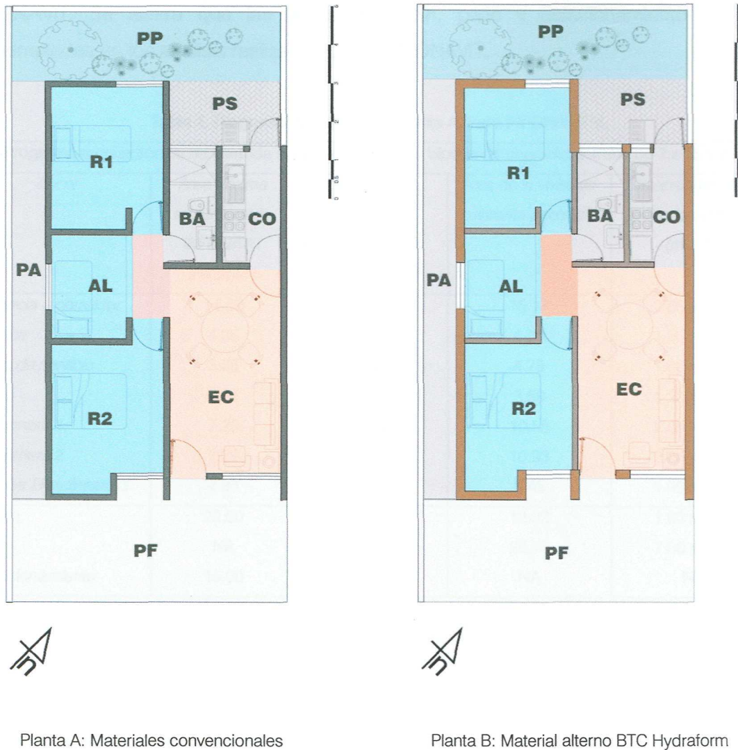
Figura 70. Comparativa entre vivienda de material convencional y vivienda de BTC
