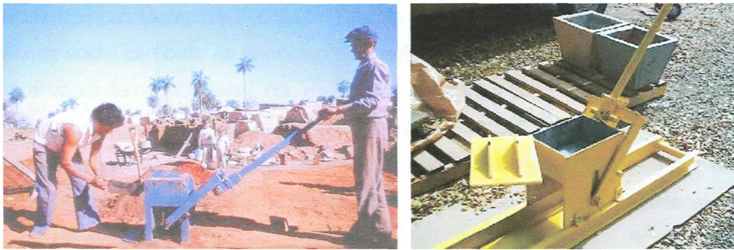
Figura 4. Fabricación de bloques de tierra estabilizados, con una prensa manual basada en la Cinva Ram.
