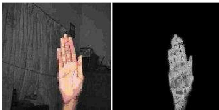
Figura 6.4: Imagen que muestra el clasificador bayesiano para la segmentación de regiones de piel. La imagen de la izquierda muestra la imagen original y, la imagen de la derecha muestra los píxeles en escala de grises, donde el valor de gris (0 - 255) indica la pertenencia a la clase piel.
