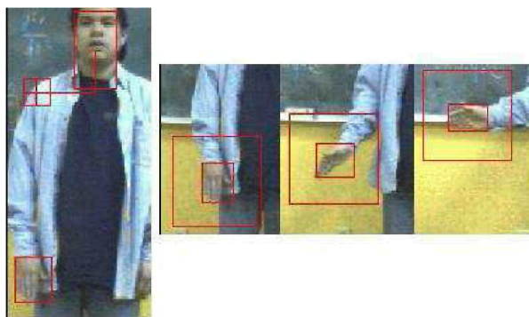
Figura 2.9: Imagen que muestra la localización y seguimiento del rostro y mano de un individuo en el sistema propuesto por Avilés. Imagen izquierda: Localización del rostro, hombro y mano. Imagen derecha: Secuencia de imágenes que muestran el seguimiento de la mano.
