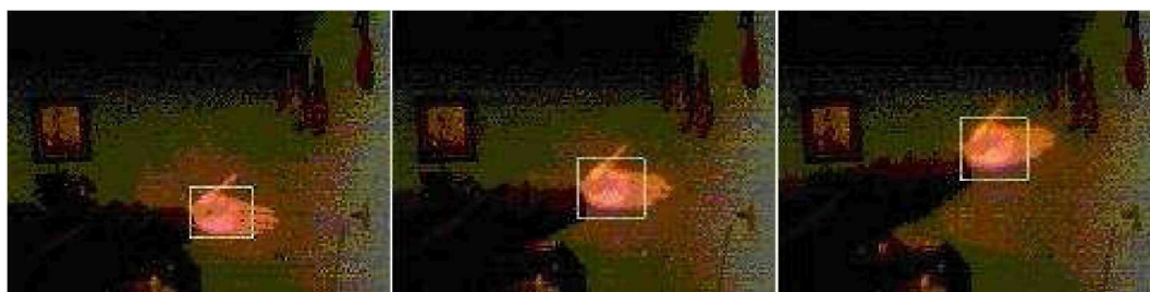
Figura 4.12: Secuencia de tres imágenes que muestran el seguimiento de la mano aplicando el algoritmo Camshift
