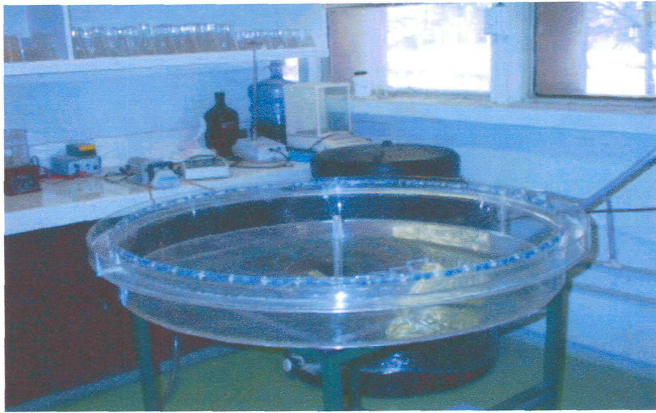
Figura 4.2 Modelo final del sedimentador.
