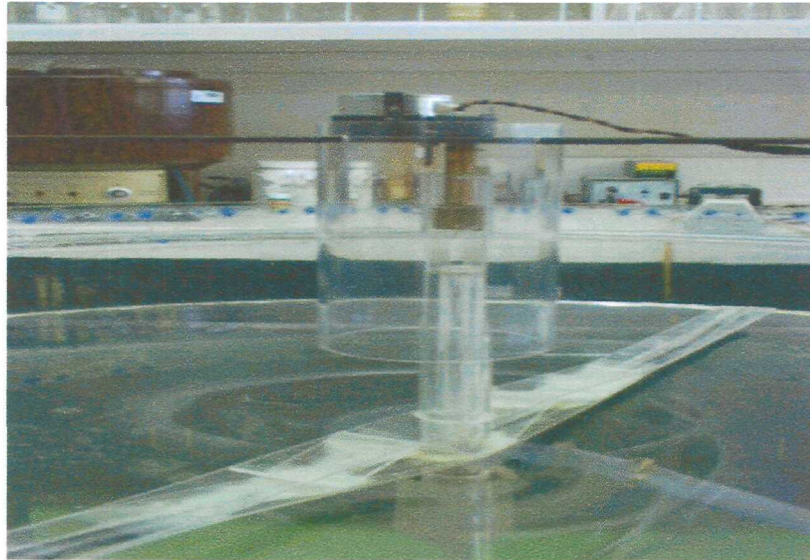
Figura 4.10 Vista de la rastra con motor y mampara de 10 cms de diámetro.
