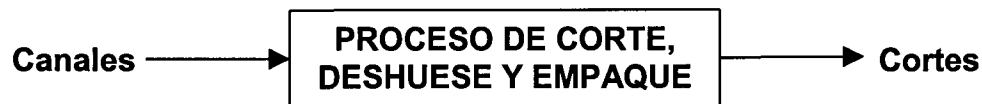
FIGURA A2.14: Diagrama de la caja negra de las empacadoras de carne.
