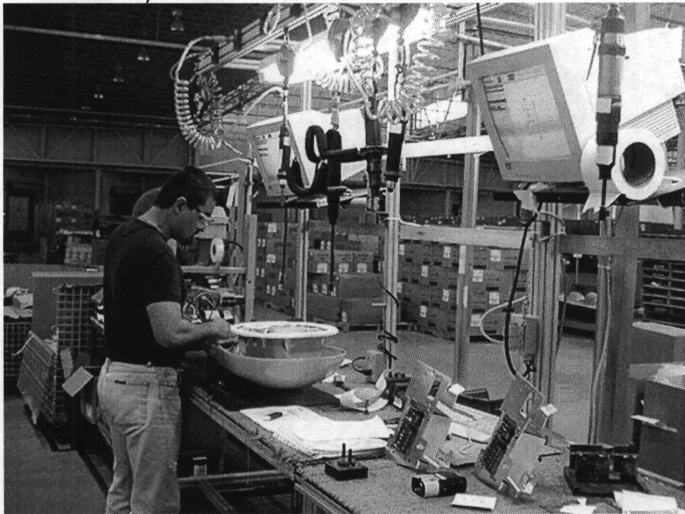
Figura 49 Celda de familia M400 (2 monitores con un solo servidor)
