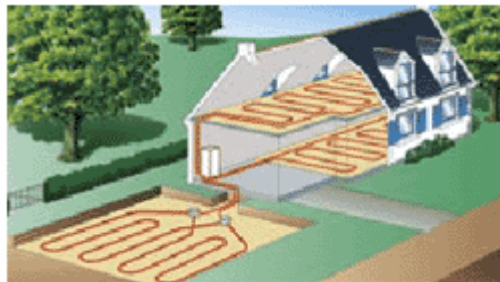
Figura 1.24: Esquema del sistema geotérmico horizontal para una casa
