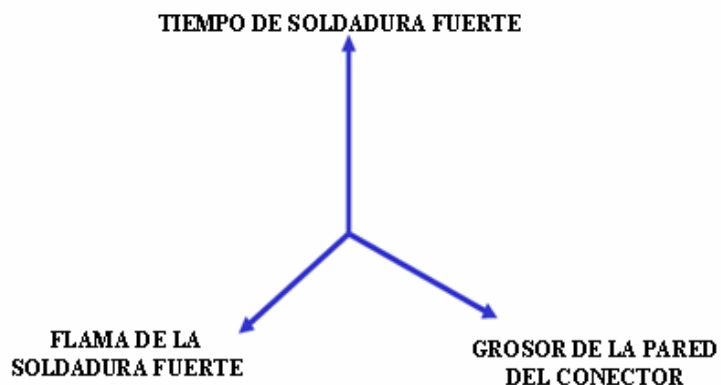
Figura 7.3 Variables involucradas en la Experimentación de la Soldadura (EMPRESA).
