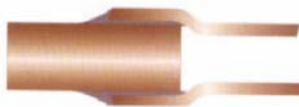
Figura 2.23 Representación esquemática del fenómeno de capilaridad (Platex (2006)).
