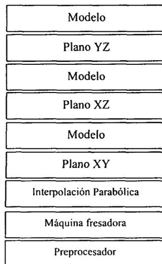
Figura 5.8. Estructura de un PreTie que soporta 3 ejes e interpolación parabólica.
