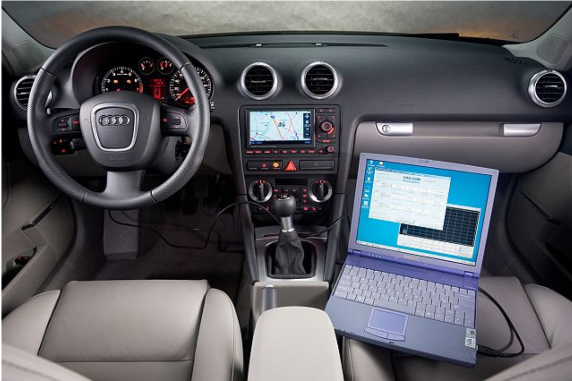
Figura 2-2 Computadora con VAG-COM utilizando un cable para conectarse al puerto OBDII
