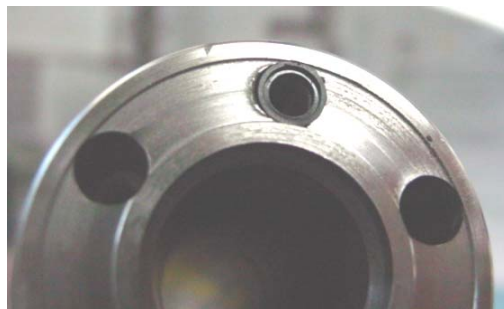
Figura 6.6 Filtro mal ensamblado
