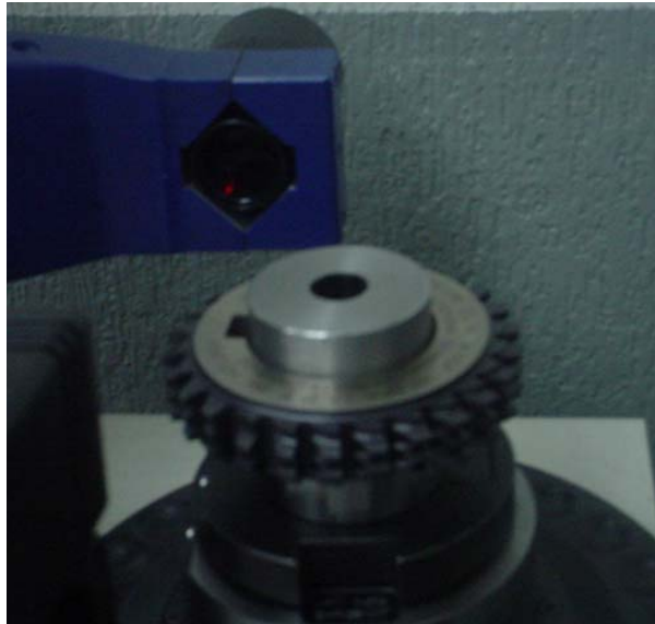
Figura 6.2 Medición de cortador en calibrador electrónico
