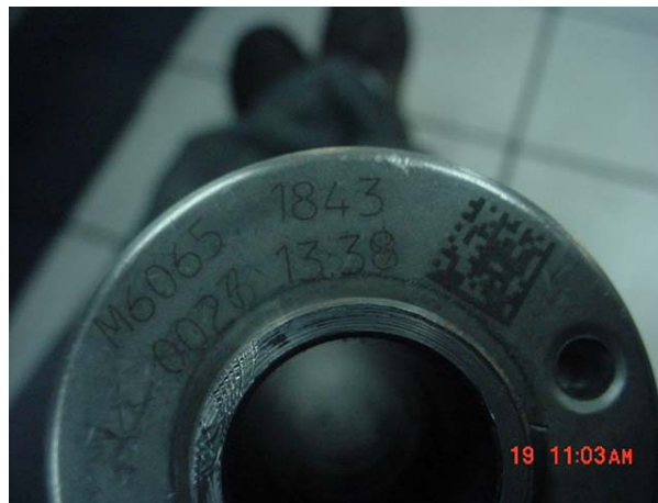
Figura 6.7 Doble marca láser
