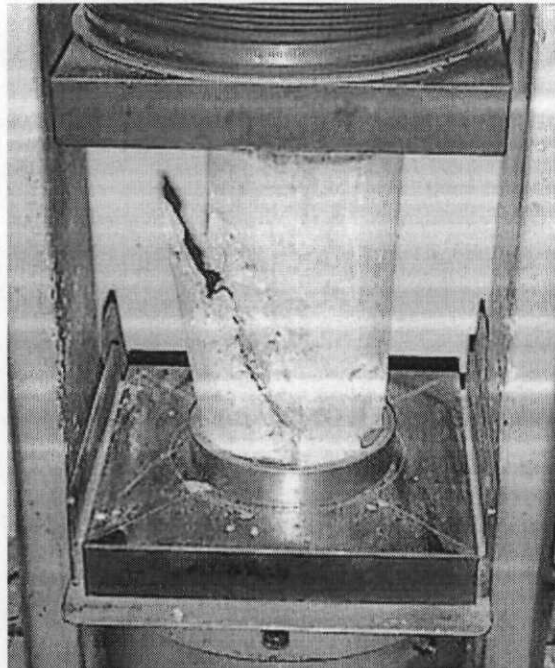
Figura 1. resistencia a la compresión de cilindros
