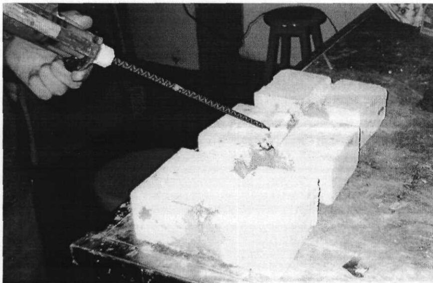
Figura 5.5, inyección de uno de los productos al murete de concreto.
