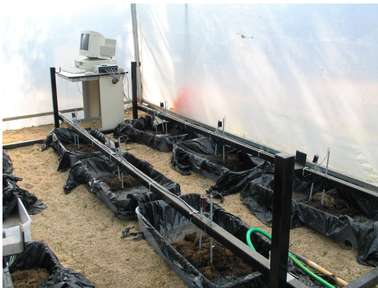
Figura. 4.4. Unidades experimentales de vermicomposteo en el invernadero del ITESM – CEM con sistema electrónico de monitoreo de temperatura y humedad.
