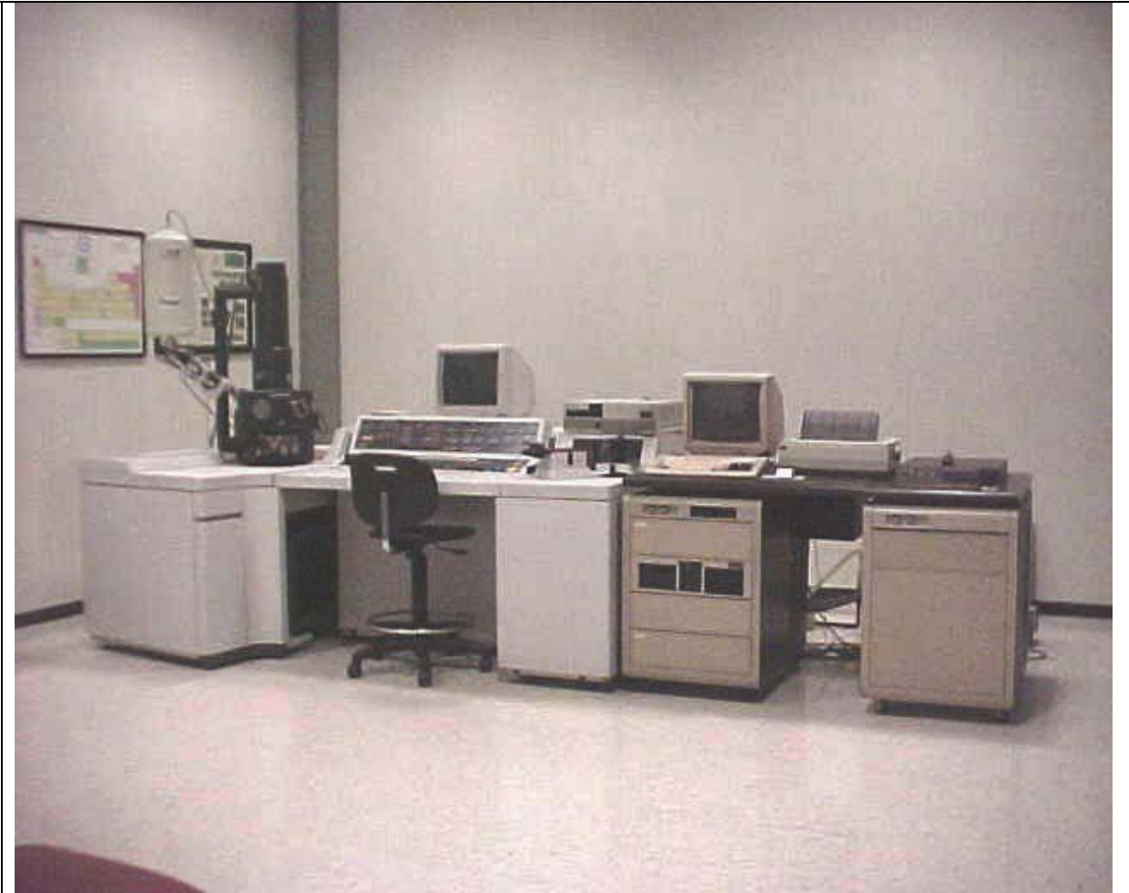
Fig. A.2 Microscopio electrónico de barrido. Marca Leica Cambridge, Modelo. Stereo Scan 360. Acondicionado con detector de electrones secundarios y detector de estado sólido de cuatro cuadrantes para la emisión de electrones retrodispersados. Equipo de dispersión de rayos X; detector de rayos X Litio Silicio marca Oxford, modelo 5526, número de serie 1080-4092, resolución 5.9 KeV a 133 eV. Equipo de análisis, marca Link analytical, mod. AN10000.
